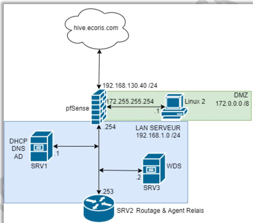
Figure 1 - Schéma réseau
